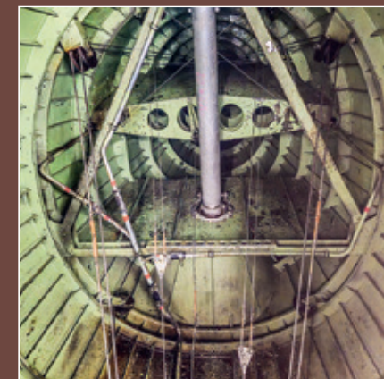
Linorna i akterkonen går till höjdroder, sidoroder och trimroder. Trimroderna sitter på höjdrodet och sidorodret.
