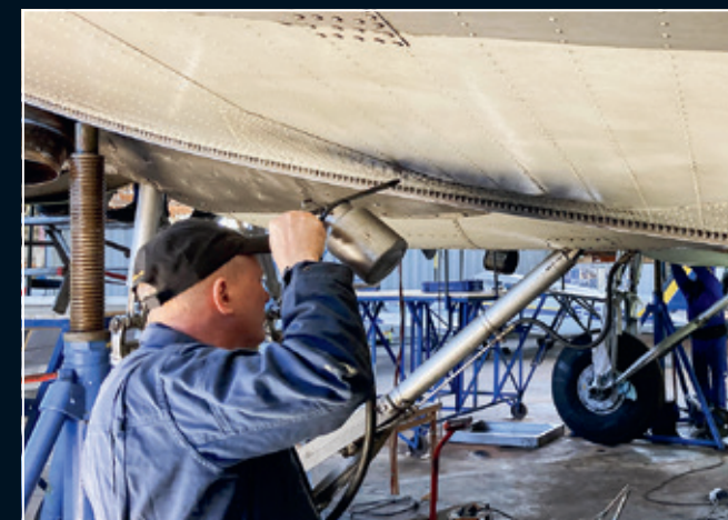
Göran Lidenvik gör rent vinginfästningarna för kontroll av eventuell korrosion. 325 skruvar och muttrar på vardera vingen. Översyn av piloternas stolar. Mekanismen för låsning av stolen i skenorna renoverad. Koll av rullbälten. Nya dyra batterierna monterade.
