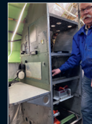
Ragge Jagero vid den nya avionics-racken. Här finns navigationsutrustning, förstärkare för högtalare i kabinen, batterier för nödbelysning och den "svarta lådan".
