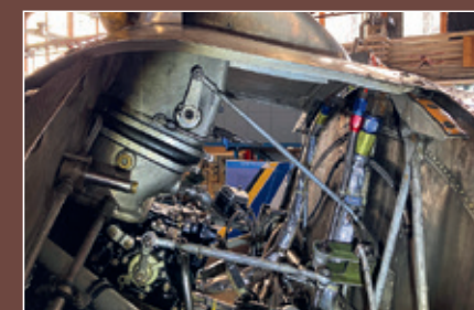
Via stänger styrs tre funktioner på förgasaren.
