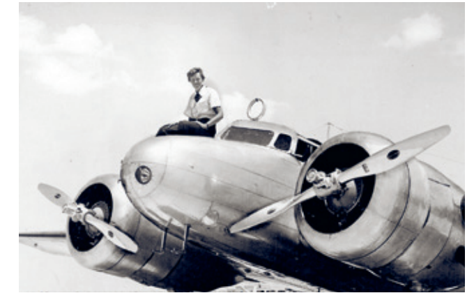
Amelia Earhart poserar på sin Lockheed Electra 10 före avfärd Jordan runt. Obs pejlantennen på taket som monterades före långresan. Den var emellertid inte avsedd för de höga frekvenser som användes.
