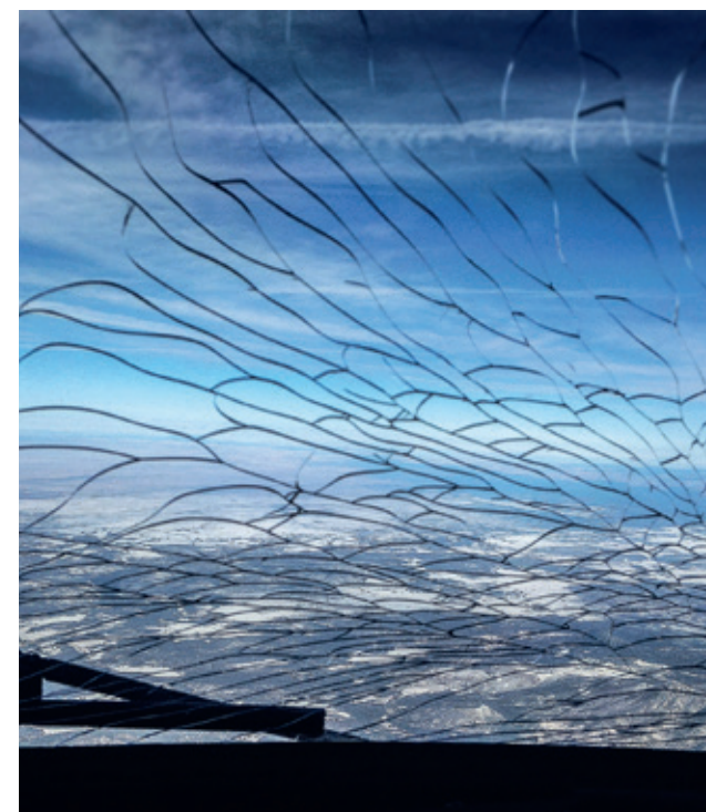
På två ferryflygningar från Las Vegas sprack en framruta när planet kommit upp på höjd. Kjell fick återvända och byta rutorna. Planen hade stått avställda i öknen i flera år. En kvinnlig tekniker byter en av de dyra framrutorna på planet.
