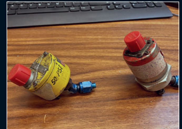
Tryckgivare för olja och bränsle sitter i hjulbrunnen och behöver rengöras och kontrolleras.
