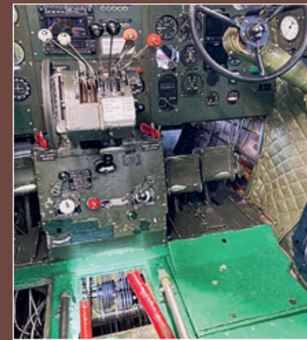
Piloternas styrspak, pedaler och reglage. Förgasaren körs med reglagen mellan piloterna. P propellervarvtal, T gasreglage, M bränsleblandning. Under golvet sitter trissor för alla linor.
