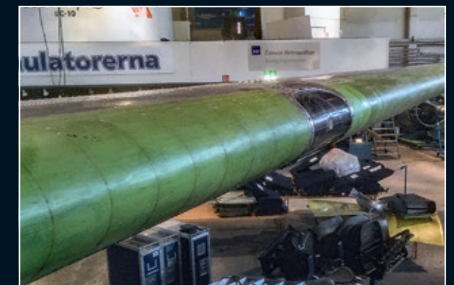
Borttagning av avisningsutrustningen på vingarnas framkant. Gummit är för gammalt, och vi kommer inte att flyga om det är risk för nedisning. Framkanten målas svart
