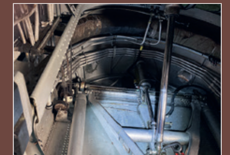
I hjulbrunnen vinklas linor framåt till förgasaren och propellerväxeln. Till höger sitter spärren till huvudstället.
