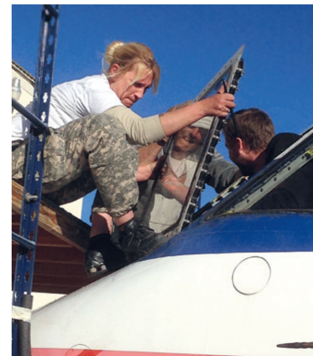
På två ferryflygningar från Las Vegas sprack en framruta när planet kommit upp på höjd. Kjell fick återvända och byta rutorna. Planen hade stått avställda i öknen i flera år. En kvinnlig tekniker byter en av de dyra framrutorna på planet.
