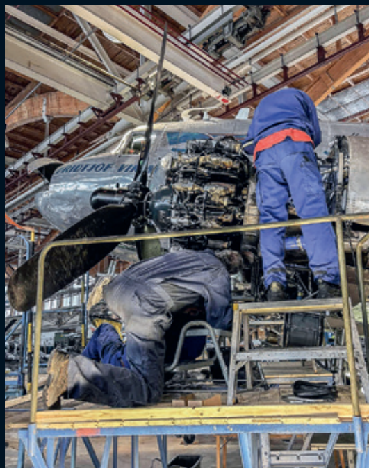
Översyn av motorerna: 2 x 28 tändstift blåstras, kompressionsprov, oljefilter. Kontroll av att avgasrören inte har sprickor. Kontroll av förgasare och byte av krånglande elektrisk bränslepump till vänster motor.
