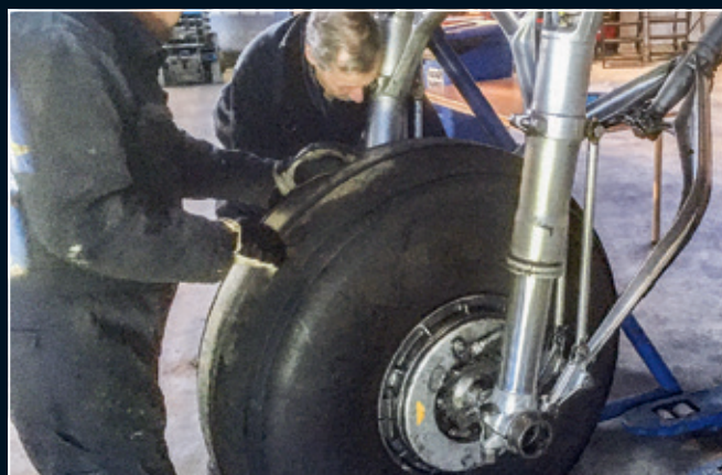
Hjulservice: Göran Lidenvik och Leif Krogstad görkontroll av hjullager och bromsar.
