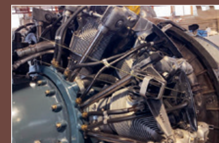
Regulatorn som styr propellerbladens vinkel.
