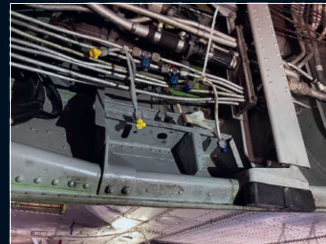
Tryckgivare för olja och bränsle sitter i hjulbrunnen och behöver rengöras och kontrolleras.
