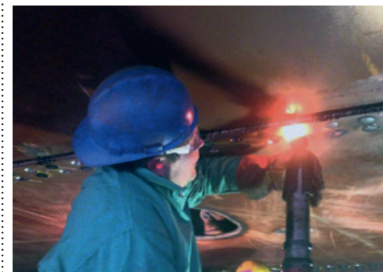
Nitning av fartygsplåtar med glödande "naglar" och tryckluftshammare som gav det öronbedövande oväsandet som hördes från varven.
