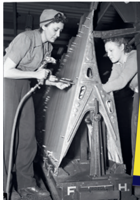
Två "Rosies" arbetar med nitning av en vinge. Den tryckluftsdrivna nithammaren till vänster och "mothållet" till höger. Här ser man hur krångligt det kunde vara att komma åt vid nitningen.
