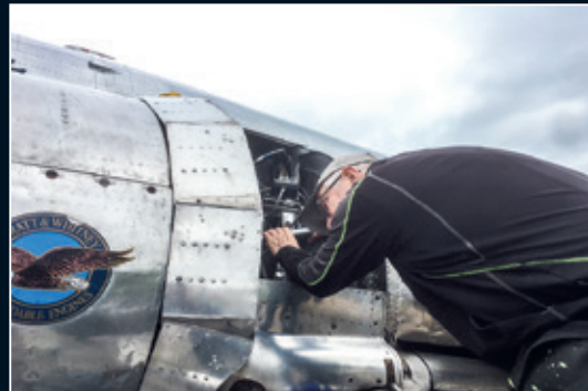
Kontroll av eventuella olje- och hydraul-läckage.
