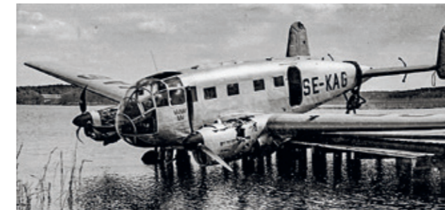
Kartverkets Siebel SE-KAG. Den stora glasnosan gjorde den lämplig för kartverkets observationer. Här efter bärgning ur Mälaren där flygplanet landat självt sedan besättningen lämnade flygplanet i fallskärm då höger landställ inte kunnat fällas ut. Flygplanet reparerades emellertid och fortsatte att användas.
