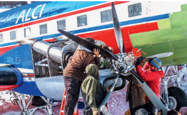
Nya turbomotorer och propellrar monteras. Obs passformen på de nya plåtarna på kroppen.
