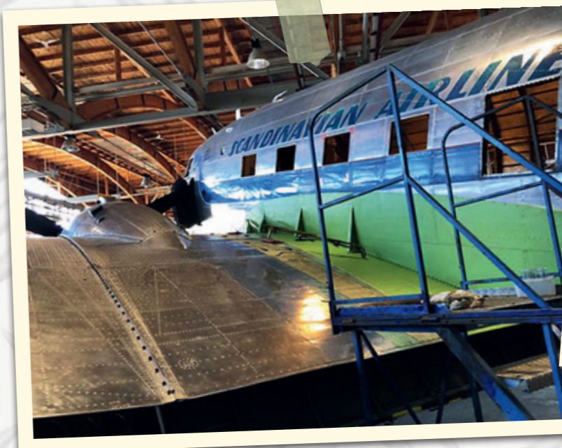
Efter målning med primer ska vinginfästningen täckas av en stor kåpa.
