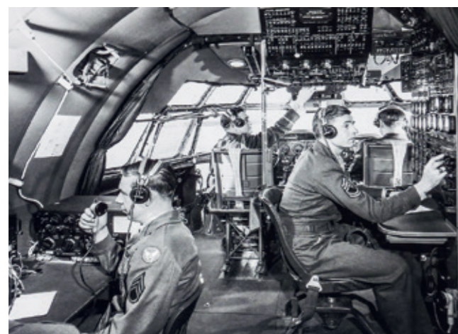
Den mycket rymliga cockpiten. Längst till vänster radiosändare ART-13 som var standard i alla B-29 plan och DC-4 - DC-6 för långdistans-kommunikation. Satt även i Daisy i flygvapnet. Finns att se FV-montern i Västerås.
