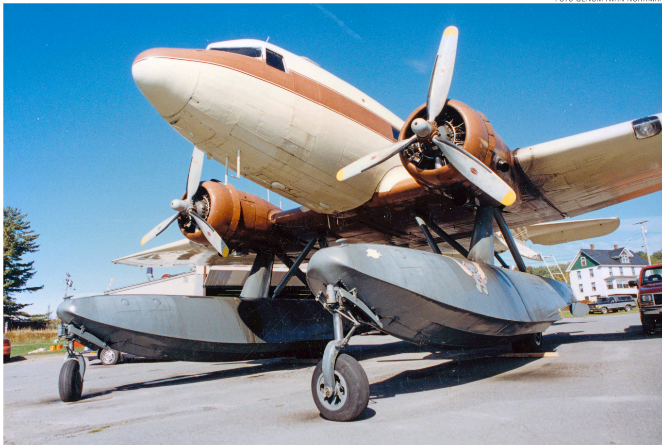
Douglas DC-3-G202A registrerad N130Q (tillv.nr 11761) på amfibieflottörer. Byggd 1943 som en DC-3A-457 C-53D Skytrooper. Flög efter kriget för Eastern Airlines. 1990 försågs planet med EDO 78-flottörer. Flygplanet är luftvärdigt 2020 och ägs av HBF Inc i Maine.
