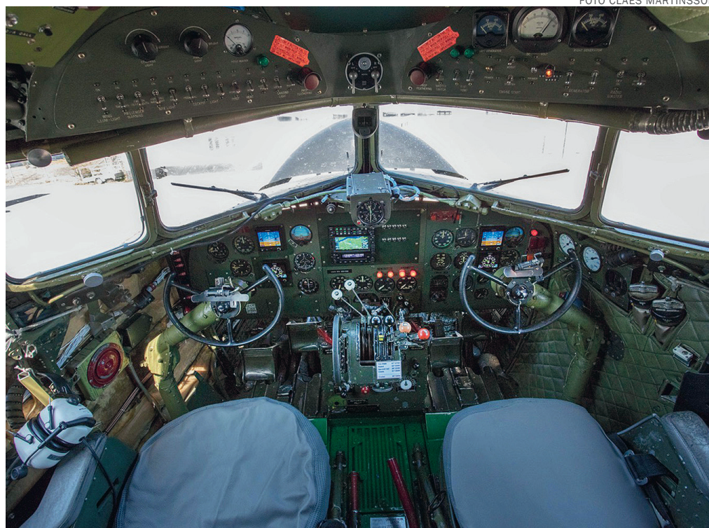
Den nya instrumentpanelen gjorde att takmonterade apparater kunde monteras bort och göra viktiga reglage och knappar lättare tillgängliga.
