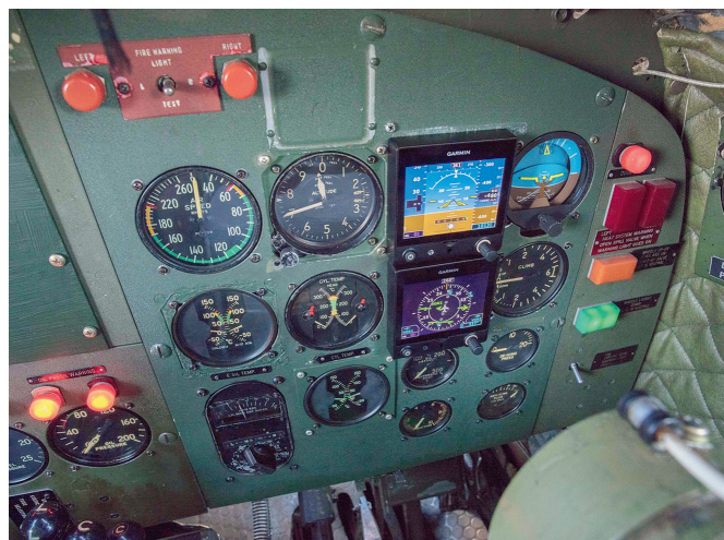
Ovan: Högersidans nya flyginstrument är identiska med vänstersidans.
