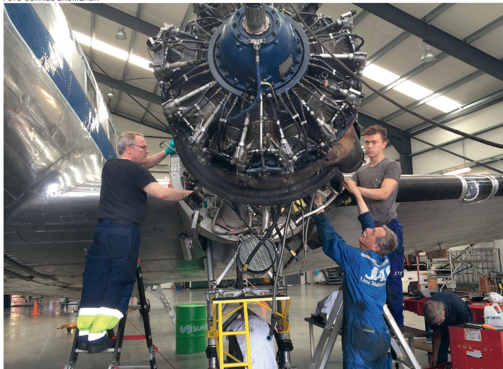
Daisy fick ovärderlig hjälp av DDA Classic Airlines tekniker på Lelystads flygplats. På bilden är det dock Flygande Veteraners Mats Oliwsson, Leif "Kroken" Krogstad och Fabian Mellberg Feher som arbetar med monteringen av den nya motorn.
